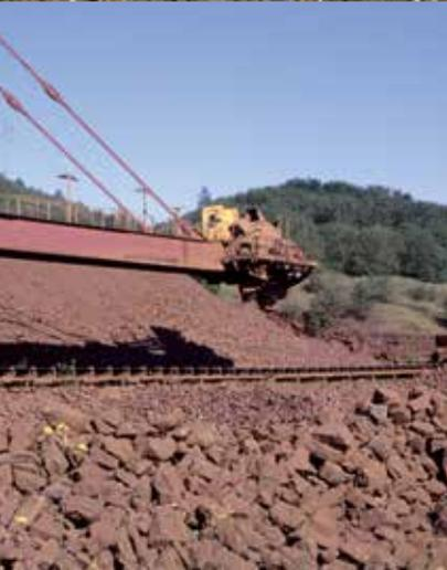
Bei dem in Luxemburg/Lothringen vorkommenden Eisenerz handelt es sich um ein oolitisches Erz, d. h., Oxyde des Eisens sammeln sich um einen Kern. Es entstehen kleine eisenhaltige Kügelchen mit einer Größe von 0,5-2 mm. Diese Oolithen werden durch ein kalkiges oder kieseliges Bindemittel zusammengehalten.
